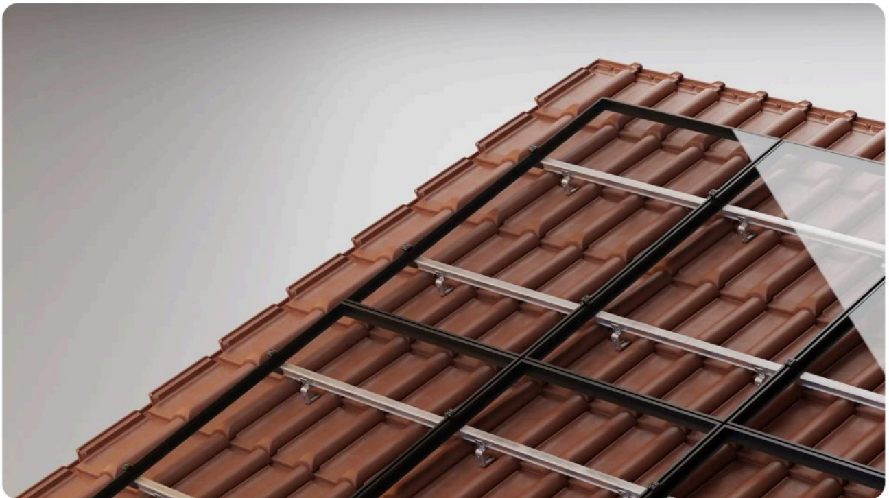
Le système ClickFit EVO en place : crochets inox réglables fixés dans la charpente → rails aluminium → panneaux clampés. Les crochets reportent le poids sur la charpente sans percer les tuiles, et la lame d'air sous les modules améliore le rendement.
